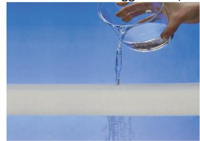
Dryfeel® è un materiale polietere reticolato a celle aperte che facilita l'eliminazione dell'umidità, beneficia di un migliore flusso d'aria e garantisce una buona capacità traspirante. La schiuma è progettata per applicazioni come imbottitura per esterni. Nei materassi può essere utilizzato anche come strato di ventilazione o come materiale per imbottitura.
